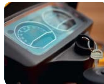
Приборка на жидких кристаллах информативна, но на свету читается плохо
